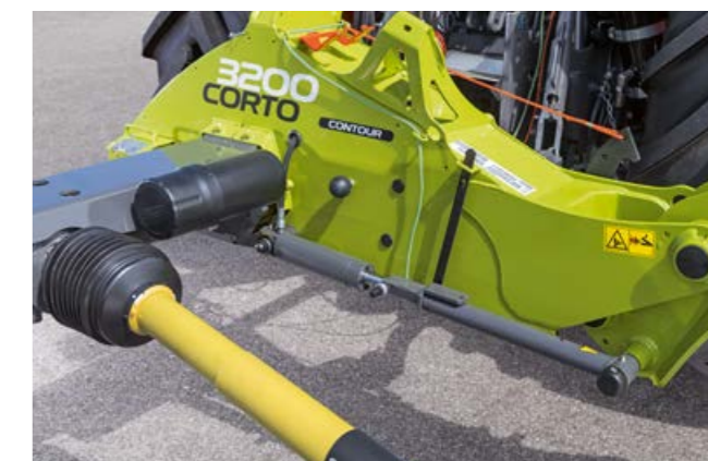
Цилиндри ACTIVE FLOAT за хидравлично регулиране на налягането на косачката CORTO 3200 CONTOUR.
