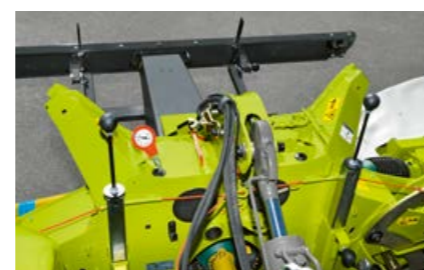
Манометър за лесна настройка на налягането за двата агрегата за косене.
