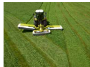
Единично повдигане на косачните агрегати в зоната на обръщане.
