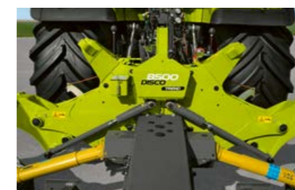
Компактна и стабилна навесна греда със серийно интегрирана система за разтоварване ACTIVE FLOAT.
