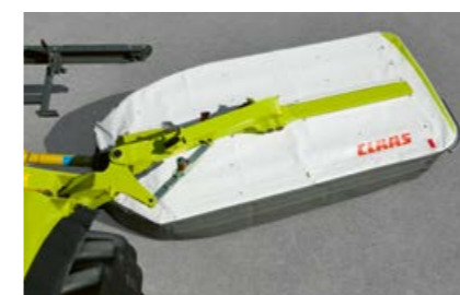
Освобождане на механичната защита срещу потегляне: Машината се накланя назад и леко нагоре при сблъсък (при DISCO 1100 TREND хидравлична защита срещу потегляне Nonstop).
