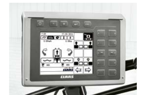
OPERATOR: ергономичен терминал за обслужване с голям дисплей и осветени бутони за избор на функциите за управление.
