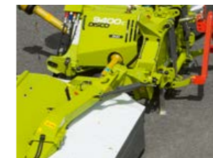
Предпазва при сблъсък чрез хидравличната защита срещу потегляне Nonstop: агрегатът за косене се люлее и се позиционира самостоятелно в изходна позиция.
