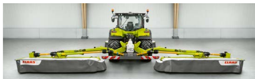
Две хидравлично управляеми телескопични стрели с безстепенно регулиране за оптимално застъпване при DISCO 1100 TREND.
