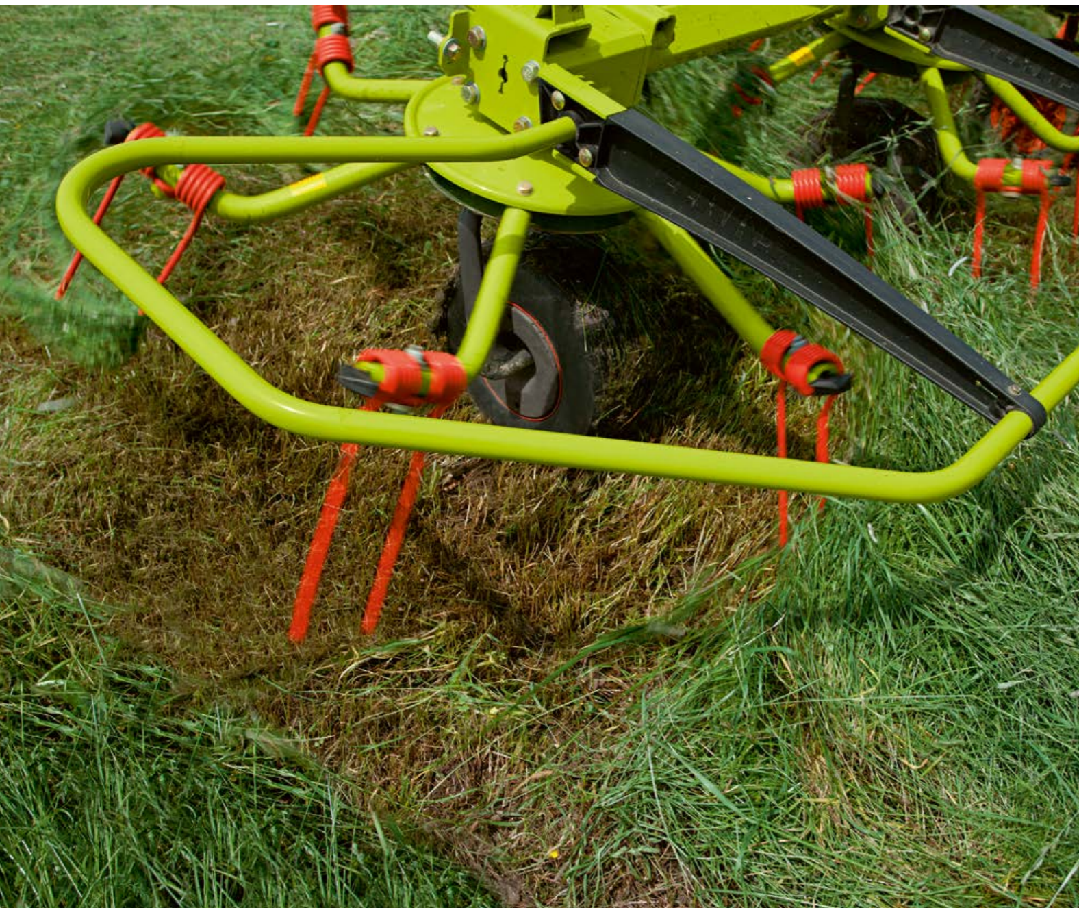
Безупречно загребване: събирането на материала се осъществява на малки порции.
